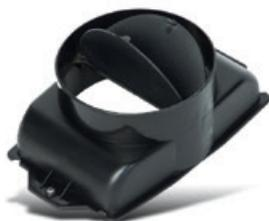
Используется в режиме отвода воздуха в вентиляционную шахту. Антивозвратный клапан представляет собой конструкцию подвижных створок у основания воздуховода. Во время работы двигателя вытяжки створки клапана открываются, обеспечивая свободный отток воздуха в вентиляционную шахту. При выключении двигателя вытяжки створки клапана опускаются, препятствуя попаданию загрязненного воздуха, неприятных запахов и насекомых из вентиляционной шахты в квартиру.
