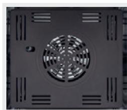
Каталитические панели установлены на заднюю и/или боковые стенки духового шкафа. На верхний слой панелей нанесен слой каталитической эмали. Принцип работы заключается в том, что при попадании частиц жира на панель происходит их расщепление. Данная химическая реакция возможна только при температурных режимах свыше 200° C.
