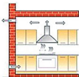
В режиме рециркуляции (фильтрующем) вытяжка не подключается к вентиляционной шахте. Для того, чтобы активизировать систему рециркуляции, необходимо установить в вытяжку угольный фильтр, который в некоторых случаях приобретается дополнительно. Гранулы угольного сорбента не только поглощают испарения и жиры, но и устраняют запахи. Использование вытяжки в режиме рециркуляции не требует дополнительного монтажа, что несколько облегчает ее установку.
