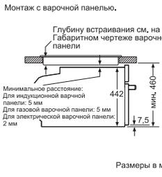
При встраивании мелких бытовых приборов под варочной панелью, необходимо учитывать требования к толщине столешницы (включая усиливающий элемент).
