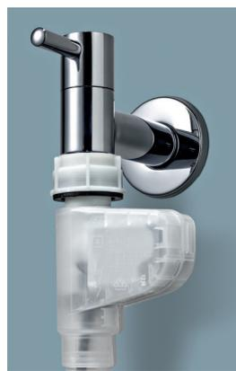
гарантирует Siemens на весь срок службы прибора. aquaStop состоит из двойного шланга для подачи воды, защитного клапана, поддона с поплавковым выключателем. Если прибор выключен, клапан остается закрытым, и вода в шланг не подается. В процессе работы прибора клапаны открываются. При возникновении протечек в наливном шланге или приборе вода скапливается в поддоне, срабатывает поплавковый выключатель, и подвод воды автоматически блокируется.
