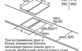
При встраивании двух и более элементов Domino непосредственно рядом друг с другом необходимо использовать один или более монтажных комплектов (2 элемента - 1 монтажный комплект, 3 элемента - 2 монтажных комплекта и т. д.).
