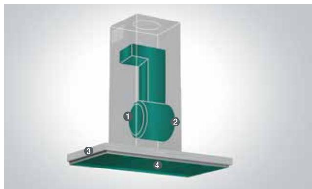
Если отвод загрязненного воздуха наружу невозможен, то используется режим рециркуляции. В этом случае воздух проходит через угольные фильтры, очищается от запахов и паров и возвращается обратно в кухню. Такие вытяжки очень просты в установке и подходят для квартир, где невозможен отвод воздуха в вентиляцию или наружу.
