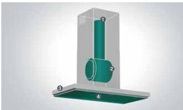
Отвод воздуха — наиболее эффективный вариант для кухни, так как позволяет максимально использовать мощность всасывания вытяжки.
