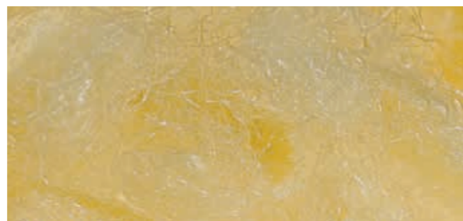
Диаметр волокна: 10 микрон Площадь поверхности: 1000 см 2 /г
